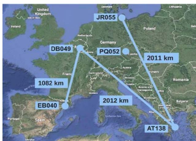
Figure 2 : Le réseau européen des sondes ionosphériques digitales DPS4D. Chaque sonde est référencée par son code international (DB049 pour la sonde de Doubes, par exemple). Les lignes qui relient certaines sondes représentent les liens les plus fréquemment utilisés. Le réseau comporte des liaisons courte distance (moins de 1000 km) et des liaisons longue distance (plus de 1000 km).
