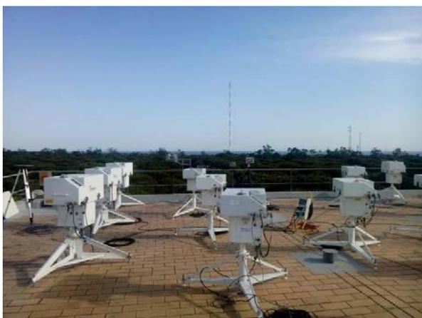
Figure 1 : Plusieurs spectrophotomètres Brewer lors d'une campagne de comparaison
