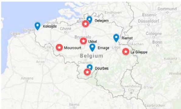
Localisation des capteurs BELLS, avec en rouge les capteurs SAFIR et en bleu les nouveaux capteurs LS7002.
